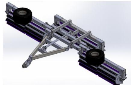
**Recebendo o equipamento:** efetuar a montagem dos pneus / rolos laterais / cabeçalho e cilindro hidráulico.
